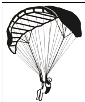
Figura 6–27. Le "orecchie" consentono un rapido smaltimento di quota in una configurazione relativamente stabile.
