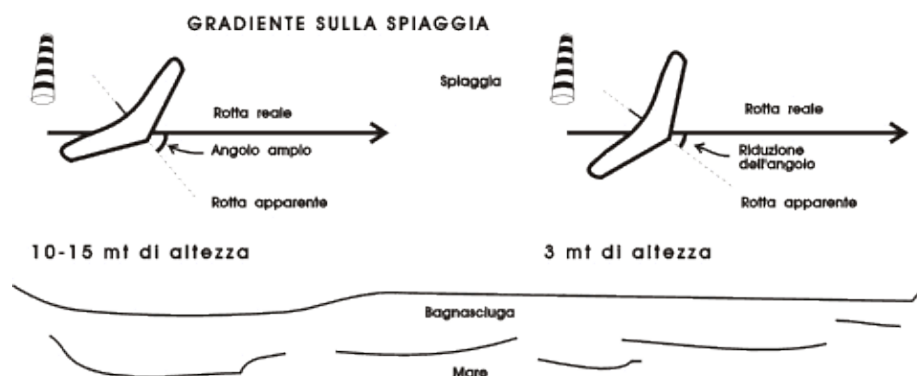
Figura 5-31. Il gradiente di vento sulla spiaggia deve essere compensato da un graduale cambiamento della rotta apparente.
