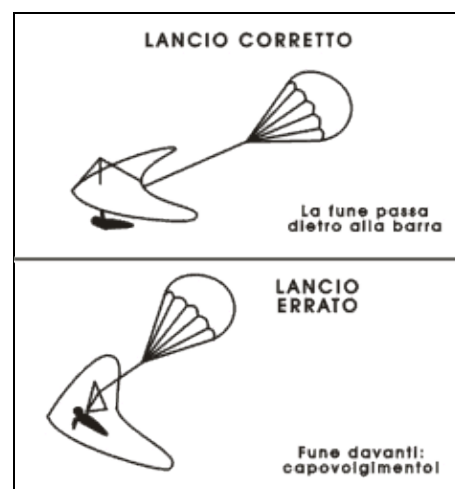
Figura 5-10. Il paracadute deve essere lanciato dietro la barra di controllo per consentire una discesa regolare.
