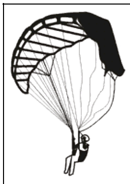
Figura 6-28. Chiusura laterale di media entità; non pone particolari problemi di recupero.
