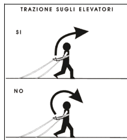
Figura 6-9. La trazione sugli elevatori deve essere rivolta in avanti ed in alto.
