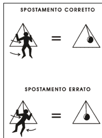
Figura 5-11. Per pilotare il deltaplano è necessario spostare il proprio baricentro, il che implica un certo sforzo muscolare
