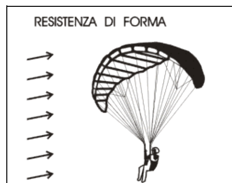
Figura 3-12. Resistenza di forma: cresce al crescere della velocità ed è proporzionale alla superficie esposta al vento relativo.
