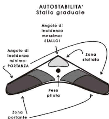
Figura 5–32. Le estremità alari sviluppano ancora portanza quando la parte centrale è già stallata.
